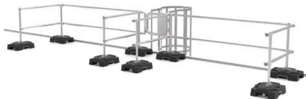
Le garde-corps pour échelle d'accès VSS Compact crée une protection de 10' de chaque côté de l'échelle et un couloir de circulation menant vers le centre du toit. Parce qu'ils partagent les mêmes composants, la ligne d'avertissement permanente VSS Safetyline se connecte parfaitement au garde-corps pour échelle d'accès afin de créer une protection antichute sans faille.
